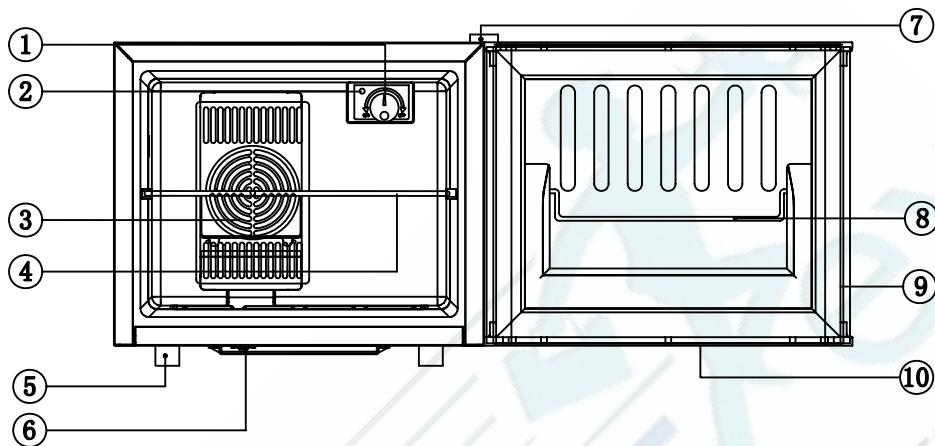
1. Кнопка регулирования температура
